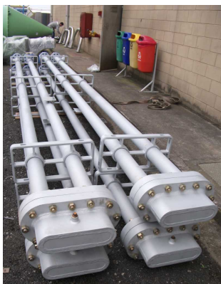
Permutador de calor
